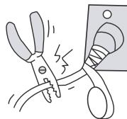
Не применяйте удлинители силовых линий и не используйте розетку для одновременного питания другой электрической аппаратуры. Это может привести к поражению электрическим током и возникновению пожара.
