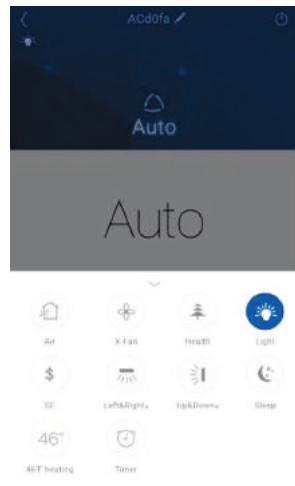
Настройте качание жалюзи. Нажмите кнопку **Up&down swing** или **Left&right swing**, чтобы включить или выключить качание горизонтальных или вертикальных жалюзи. Нажмите на стрелку в нижнем углу иконки, чтобы перейти на страницу настройки диапазона качания жалюзи.
