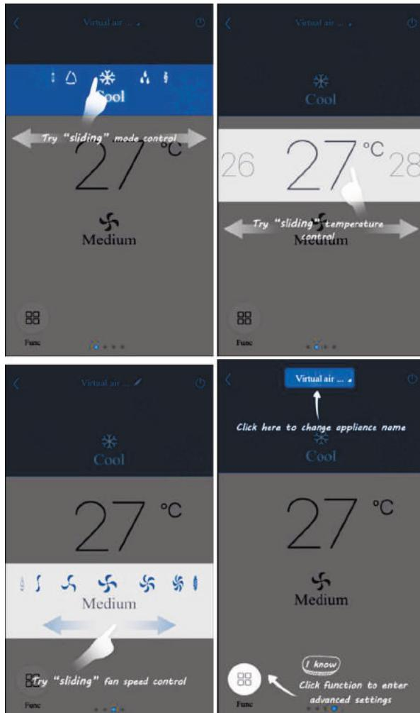
Настройте дополнительные функции. Нажмите кнопку **Func** в нижнем левом углу, чтобы перейти к списку функций. Нажимайте на иконки в списке для включения или отключения соответствующих функций.
