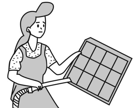
1. Откройте внешнюю панель, возьмитесь за ярлычок воздушного фильтра и, слегка приподняв его, извлеките фильтр.
